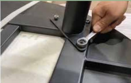
Aynı anahtar ile alt tepsi vidaları sağlam şekilde sıkılır.
