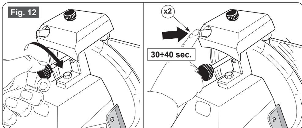
5. Après vous être assuré de la formation de la bavure, actionner à nouveau l'interrupteur (1) pendant 3/4 secondes en appuyant en même temps sur les boutons (x2 et x3);
